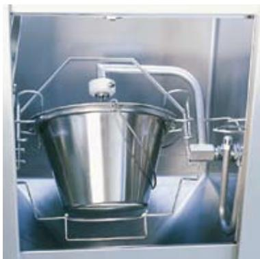
Contenedor estándar con cubo. La tapa deberá colocarse sobre el soporte de montaje lateral.
