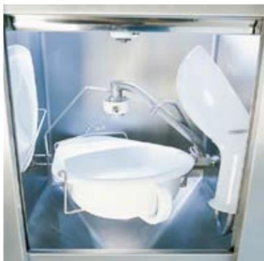
Soporte para cuñas de forma alargada. Este soporte gira en la dirección opuesta con el asa hacia fuera. La tapa deberá colocarse en la parte lateral de la cámara y la botella de orina sobre la tobera saliente.
