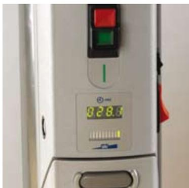
El Indicador de Descarga de Batería opcional muestra el estado de la batería, mientras que el cuentaminutos se encarga de supervisar y determinar la actividad de la *Maxi Move*.
